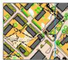
Rys. 2. Skala 1:10 000, usunięto część szczegółów. Mapa jest czytelna, ale zawiera mniej informacji niż mapa w większej skali.
